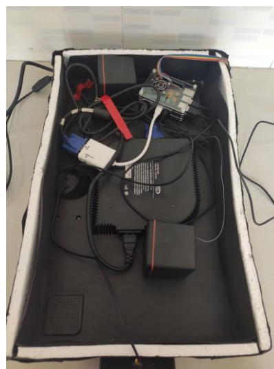
Rajah 13 Raspberry Pi 4 yang telah diintegrasikan bersama perkakasan
