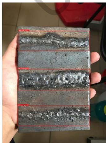
Rajah 3.5 Contoh Paparan Imej Kimpalan dengan Keputusan Pengesanan YOLOv8
