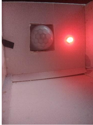
Rajah 5.2 Lamp LED1 dan PIR1 berfungsi
