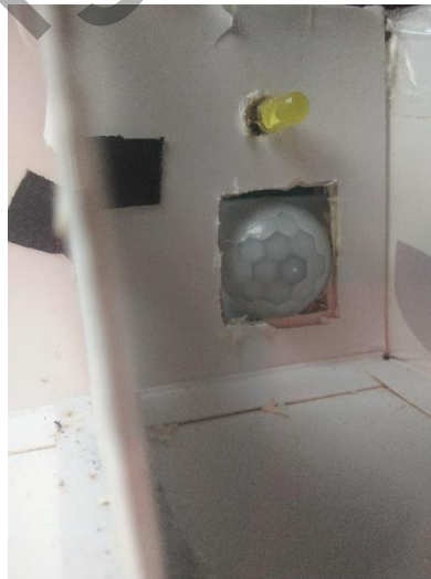
Rajah 5.7 Lampu LED4 dan PIR4 tidak berfungsi
