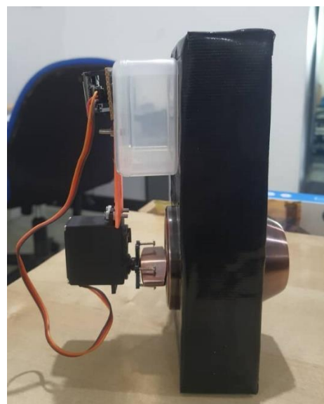
Rajah 5.29 Alat pengunci pintu pintar pada tombol pengunci pandangan depan
