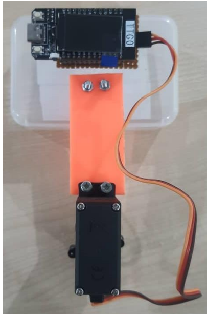
Rajah 5.27 Alat pengunci pintu pintar pandangan depan
