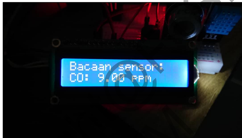
Rajah 5.6 Paparan kelima LCD memaparkan bacaan karbon monoksida (CO)
