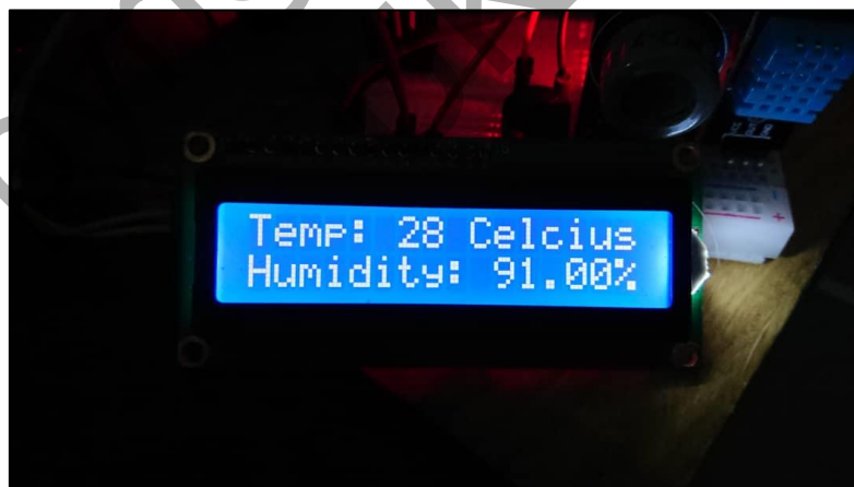
Rajah 5.7 Paparan keenam LCD memaparkan bacaan suhu (Temp.) dan kelembapan (Humidity)
