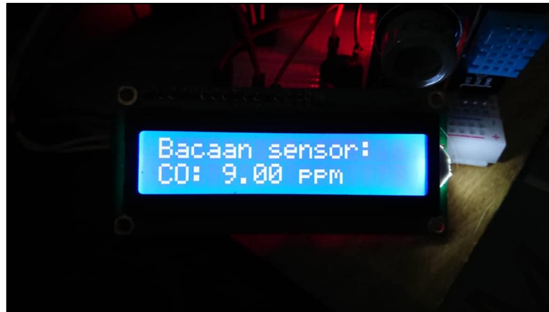
Rajah 5.8 Paparan ketujuh LCD memaparkan bacaan karbon monoksida (CO) kali kedua bagi memastikan pengguna tidak terlepas pandang
