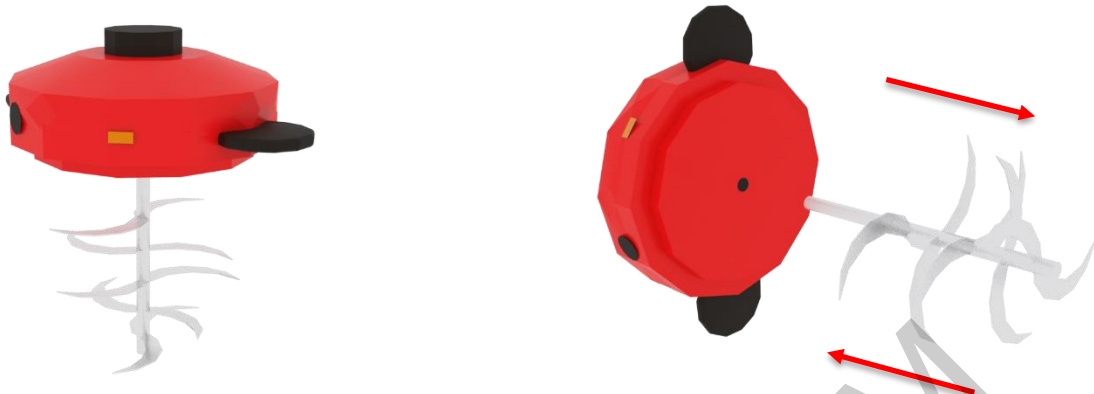
Rajah 16: Simulasi tiang bilah pisau dikeluarkan daripada penutup dan dimasukkan dengan rapi dan kukuh (bahagian pemegang tiang bilah pisau diperbuat daripada getah bagi penutupan rapi)
