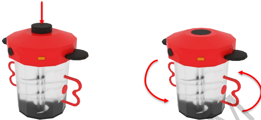
Rajah 14: Simulasi menekan butang di atas untuk memulakan pemotongan dan pergerakan pemotong sehingga butang dilepaskan
